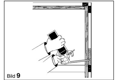
4. Montage der Bänder durch die mitgelieferten Schrauben in den dafür im Futter vorgesehenen Bohrungen oder als zusätzliche Möglichkeit empfehlen wir den Bandteil im Bereich der Bandbefestigungslöcher mit dem Mauerwerk zu verschrauben. In diesem Fall muss die Luft zwischen Mauerwerk und Futterrückseite ausgeklotzt werden (siehe Bild 1 und 2).
